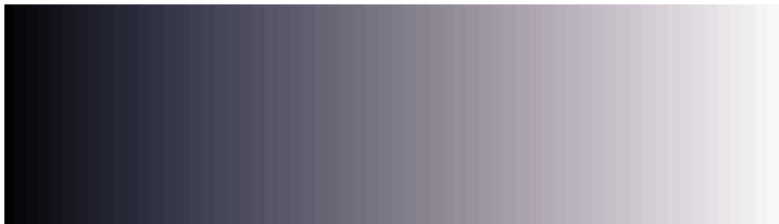
Met Softwarematige Kalibratie zijn kleurzwemen en verticale banden in een grijswaarde patroon zichtbaar.
